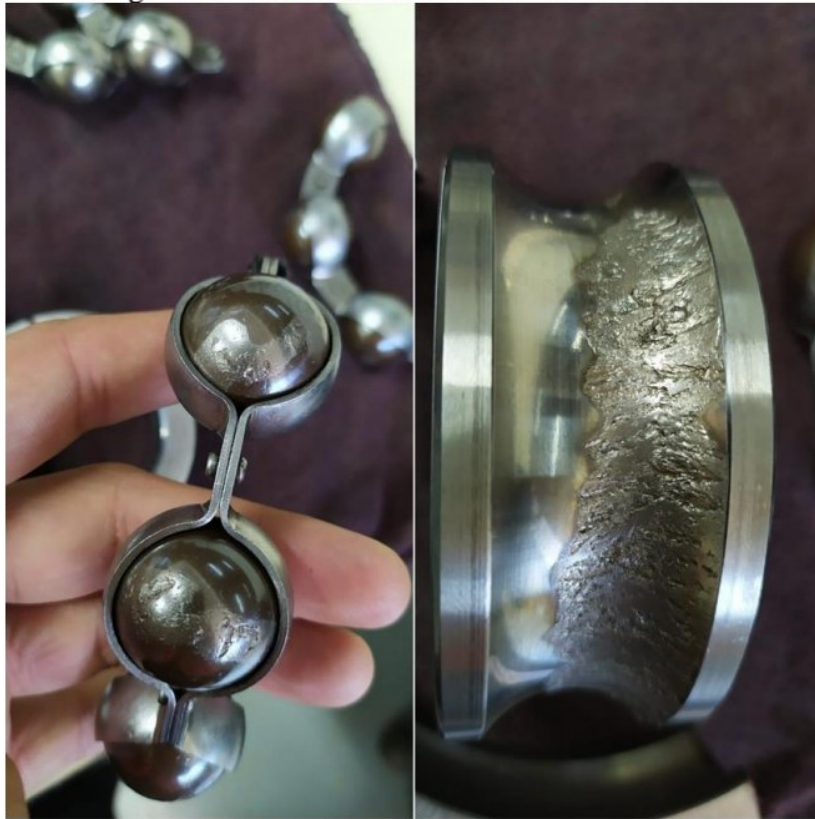
Figura 10 - Pista interna de rolamento danificado
