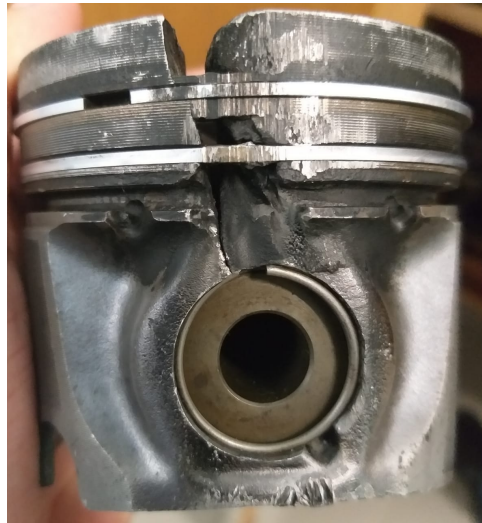
Figura 7 – Pistão derretido (vista lateral) devido ao fenômeno Knock
