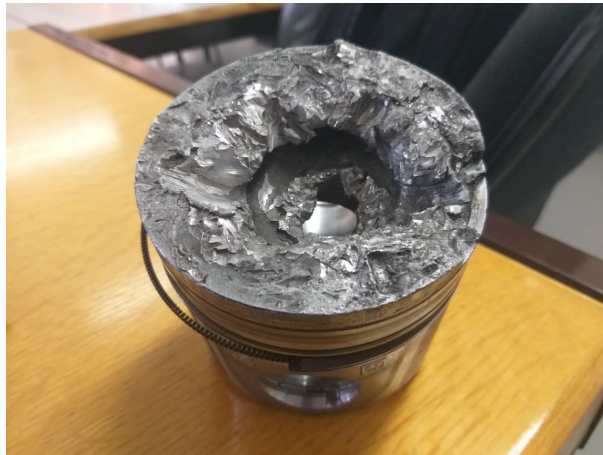
Figura 6 – Pistão derretido devido ao fenómeno Knock
