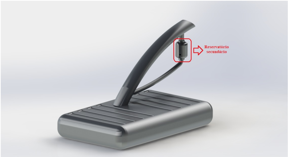
Figura 16 – Suporte para o sensor (reservatório secundário)
