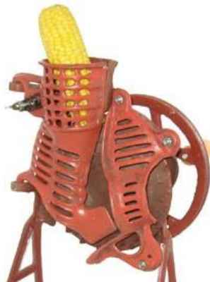
Figura 25: Espiga de milho no Debulhador
