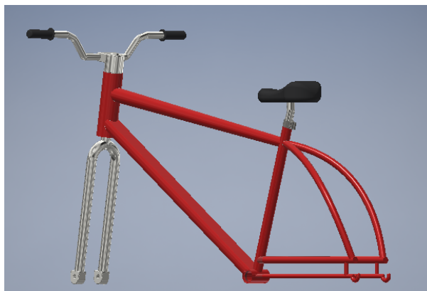
Figura 14 – Modelagem do guidom, banco e garfo fixados ao quadro.
