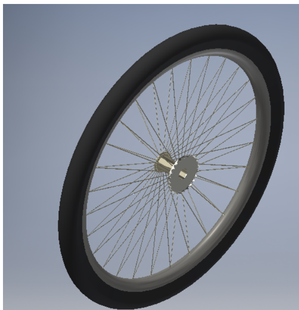
Figura 13 – Modelagem da coroa posterior fixada a roda traseira.
