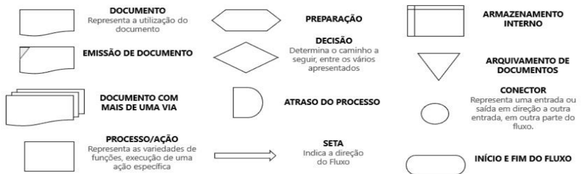
Figura 2 - Símbolos de um fluxograma de processo
