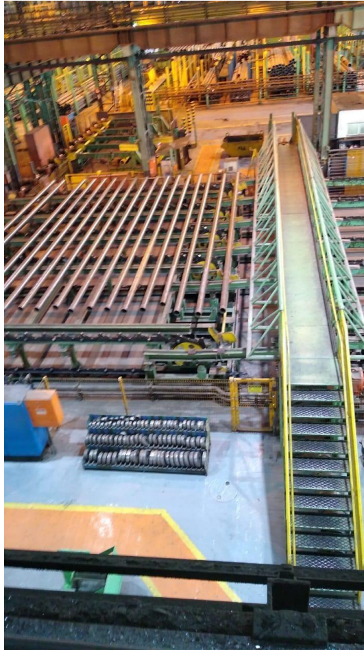
Figura 8 - Fotografia da banca de interligação têmpera-ajustagem.
