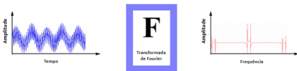
Figura 13 – Transformada de Fourier
