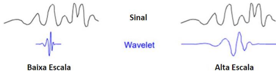
Figura 18 – Sinal Com Fatores de Escala Distintos
