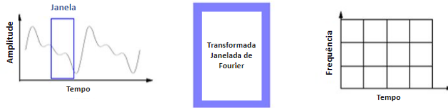
Figura 14 – Transformada Janelada de Fourier
