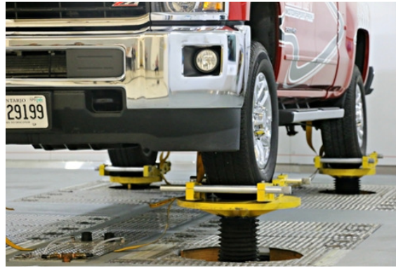
Figura 4 - Simulador de estrada com quatro atuadores.
