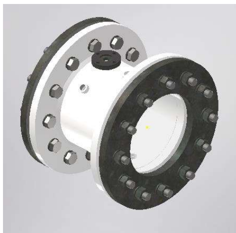
Figura 15 - Câmara hiperbárica que será utilizada nos ensaios em meio aquoso. FONTE - (CARVALHO, 2020. Adaptado)
