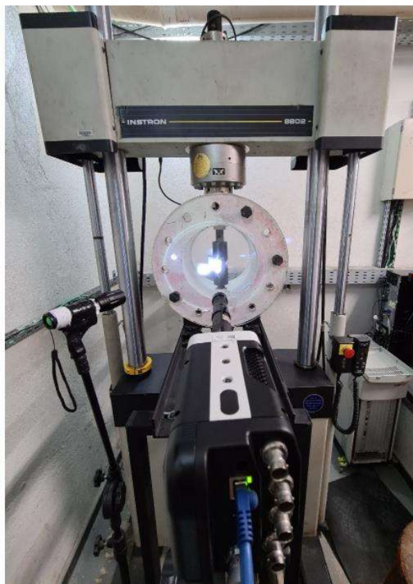
Figura 19 - Posicionamento da câmera junto à máquina INSTRON FONTE - (CARVALHO, 2020)
