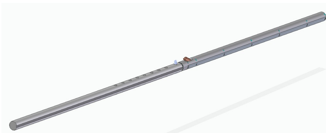
Figura 42 - União entre os eixos de mandrilar e de soldagem.
