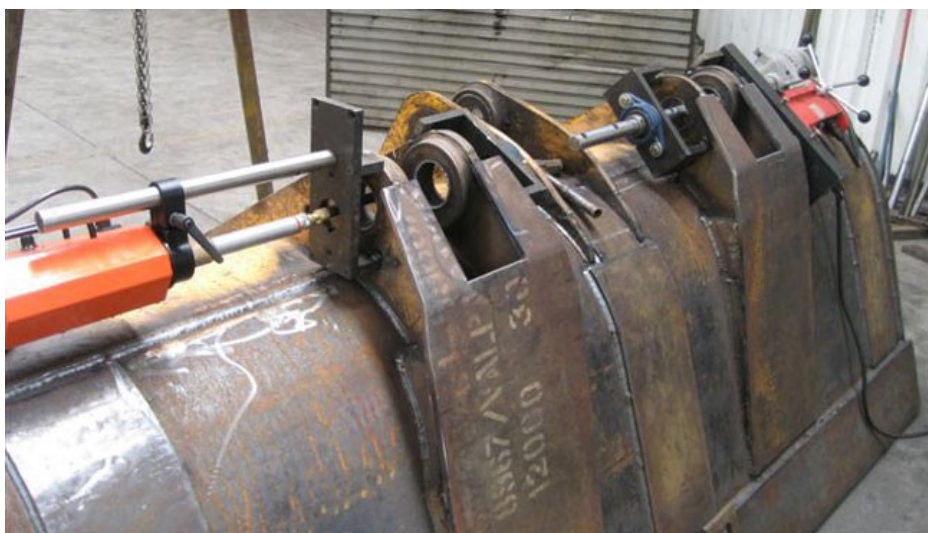
Figura 1– Atividade de preenchimento de um furo por soldagem Mig-Mag (direita) e a atividade posterior, sendo a de mandrilhamento, em outro furo já preenchido (esquerda).
