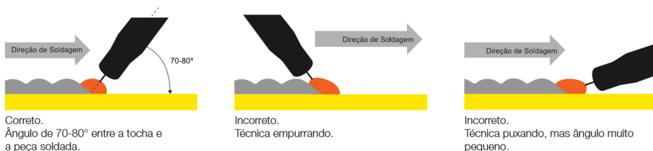
Figura 27 - Sentido de soldagem e ângulo de trabalho do bico.
