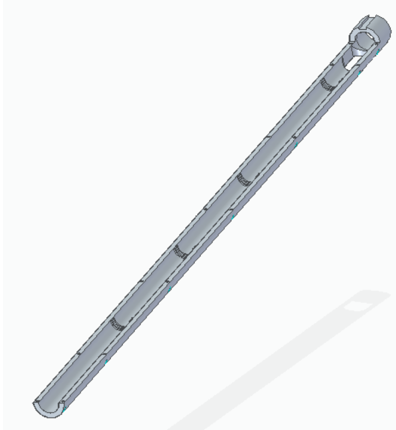
Figura 23 - Corpo do eixo de soldagem.
