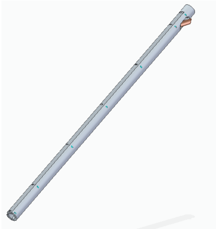
Figura 26 - Montagem completa do eixo de solda.
