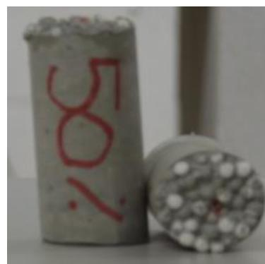
**Figura 8 – Amostra com 50% de EPS.
