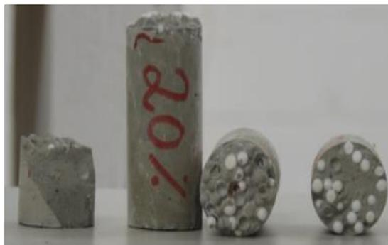
**Figura 5 – Amostra com 20% de EPS.
