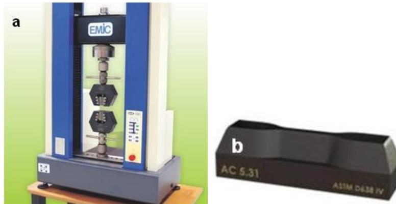
**Figura 1: (a) Máquina Universal de Ensaio modelo EMIC DL 20000 (IFMG - Mecânica) e (b) Faca de corte para estampagem de corpos de prova tipo IV segundo a norma ASTM D- 638.**
