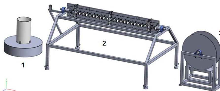
**Figura 4 – Desenho esquemático tridimensional da máquina de Endireitamento Híbrido.**
