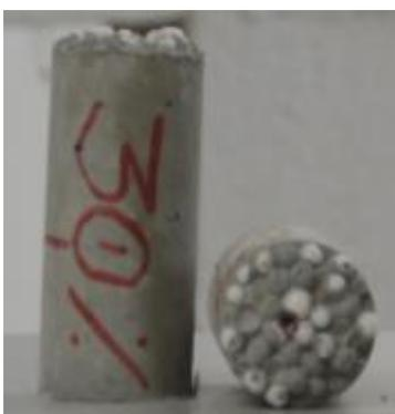
**Figura 6 – Amostra com 30% de EPS.
