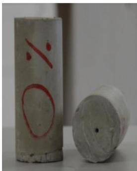
**Figura 3 – Amostra com 0% de EPS.
