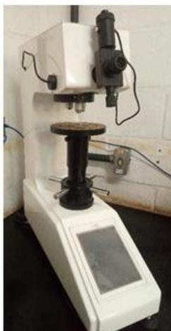
**Figura 3 – Durômetro Vickers do Laboratório de Metalografia e Ensaios Mecânicos do IFMG – Campus Congonhas.**
