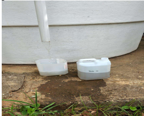
Figura 1-Coleta da amostra de efluente de entrada
