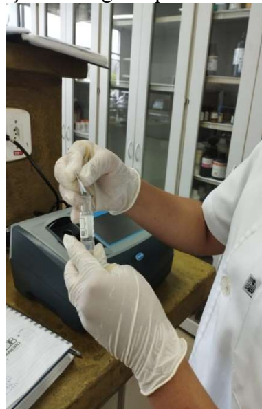
Figura 2: Adição do reagente para análise do nitrogênio
