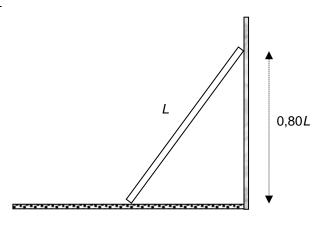
uma distância 0,80L acima do solo como mostra a figura. Um homem de peso 2P sobe pela escada e se posiciona no centro da mesma. Pode-se afirmar CORRETAMENTE que o coeficiente de atrito estático mínimo entre o solo e a base da escada, de tal forma que o homem possa ficar no centro da escada sem que a mesma escorregue é igual a:
