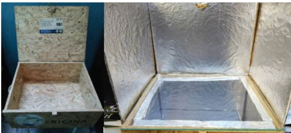
FIGURA 5 . Protótipo Forno Solar tipo Caixa.
