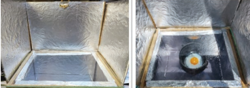
FIGURA 7 . Teste de cozimento de um ovo no forno solar.
