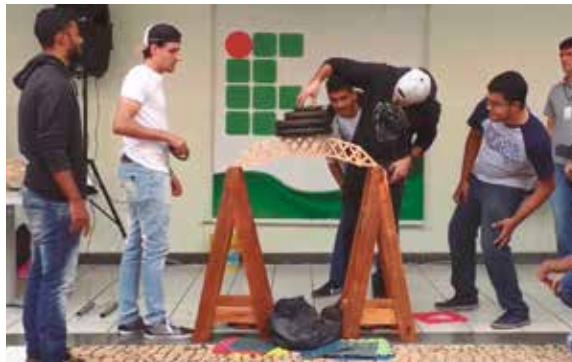
Alunos exibem seus protótipos de ponte e fazem testes com cargas
