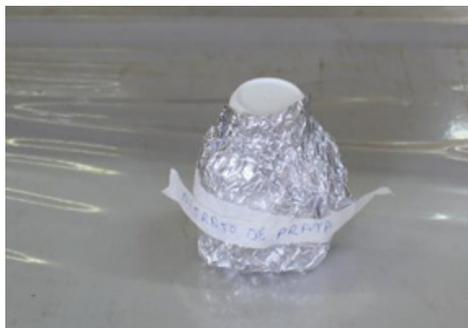
Figura 15: Forma de armazenamento da solução reveladora
