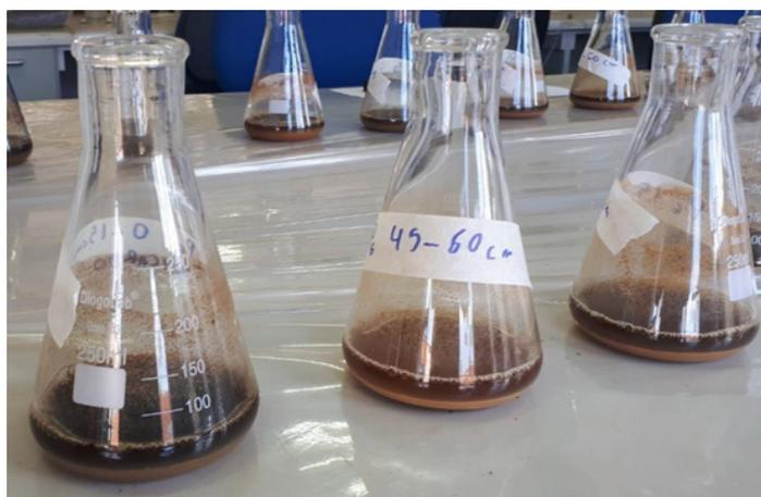
Figura 28: Líquido sobrenadante após repouso de 6 horas, sem mexer no frasco. Fotografia: Diego Alves de Oliveira, 2021
