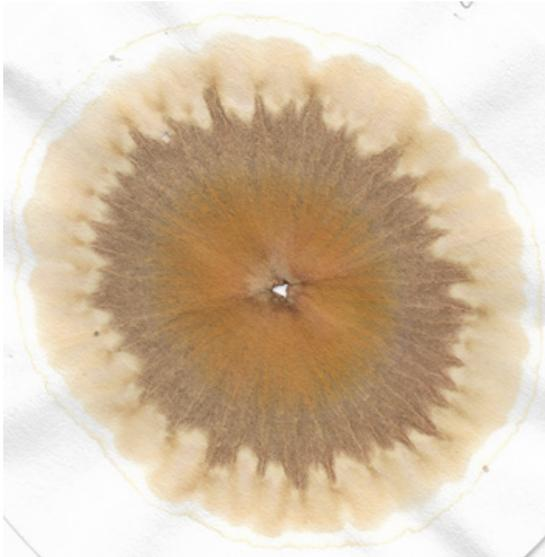
Figura 07: Exemplo de resultado da cromatografia de Pfeiffer, chamado de cromatograma produzido a partir de amostra de solo com uso da terra sob reflorestamento.
