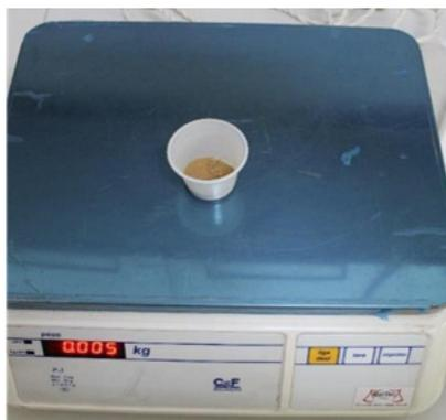
Figura 11: Pesagem de 5 gramas do solo seco e destorroado
