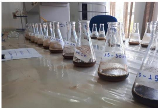
Figura 27: Soluções em repouso após agitação
