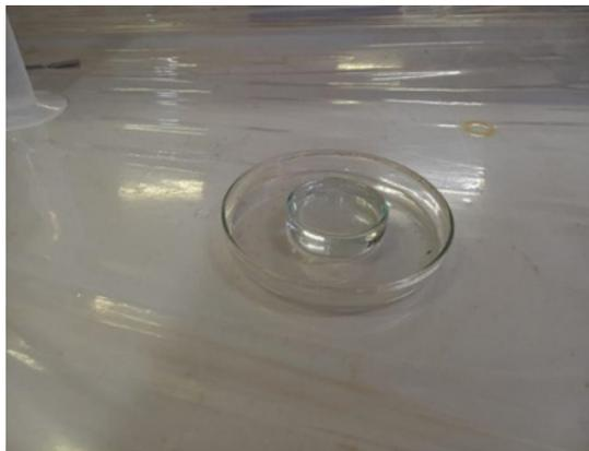
Figura 23: Posição correta em que as placas de Petri devem ser posicionadas.
