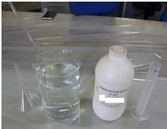
Figura 12: Itens necessários para fazer uma solução extratora
