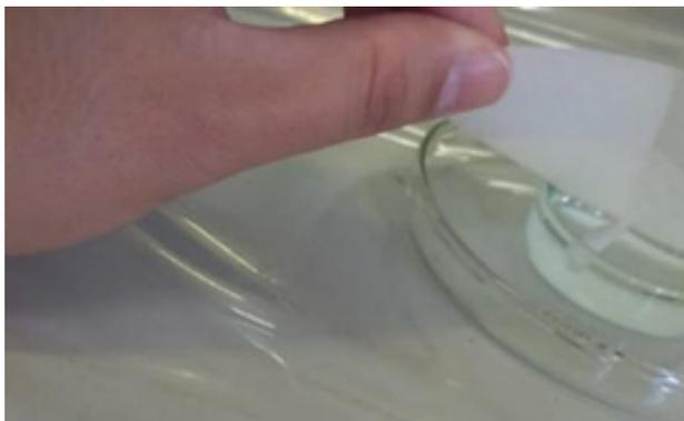
Figura 24: Colocação do conjunto capilar/papel-filtro na placa de Petri
