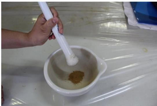
Figura 10: Processo de destorroamento do solo
