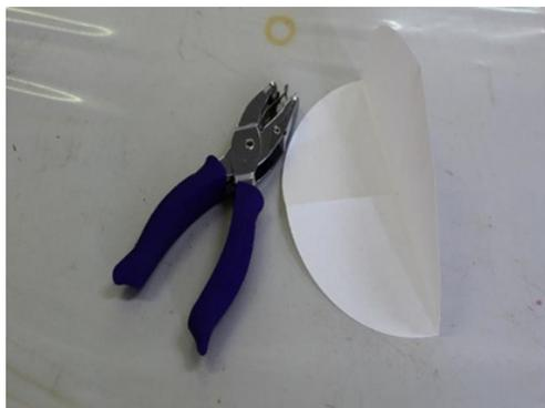
Figura 19: Furador de papel que deve ser usado para fazer o furo na região central do filtro circular. Fotografia: Diego Alves de Oliveira
