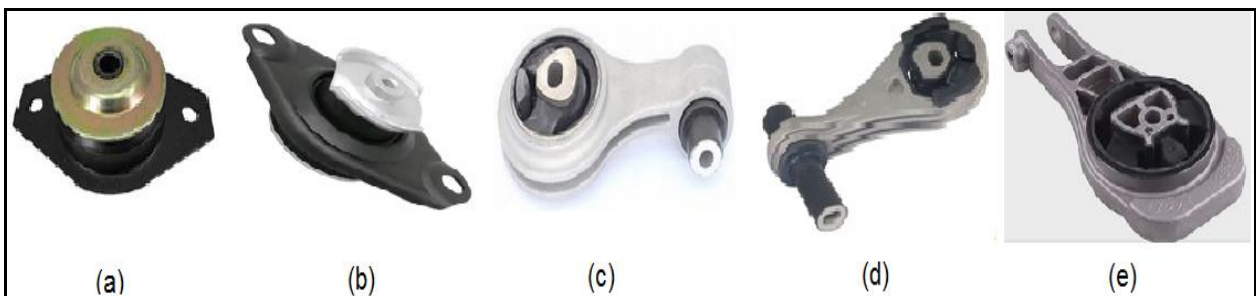
Figura 1 – Modelos, diversos, de coxins de câmbio; (a) componente usado em veículo “popular - U” fabricado entre 1986-2001, b) componente usado em veículo “popular MF”:1.0 1.3 1.4 fabricado entre -2001-2010, c) componente usado em veículo “popular - UVV” fabricado entre 2010 a 2016, d) componente usado em veículos LL, Sin“sedan médio” fabricado entre 2010 a 2016, e) componente usado em veículos Cbt, Onx, Prsm, Snc e Spn fabricados entre 2014 e 2021.
