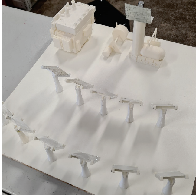
Figura 2 - Usina Heliotérmica concentrador tipo torre.
