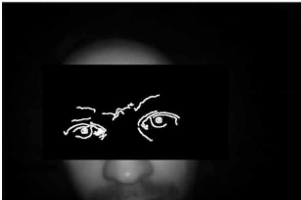
Figura 1: Frame após os comandos cvSetRoilmagem e cvCanny .
