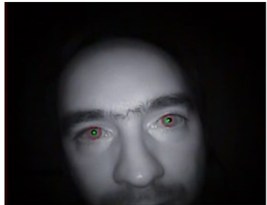
Figura 2: Olhos detectados após o comando cvHoughCircles .
