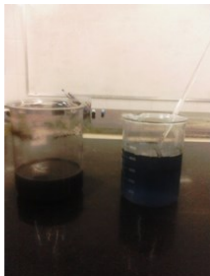
Figura 03: Formação de precipitado de \text{CuO} e decantação do sobrenadante
