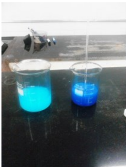
Figura 02: Adição de NaOH e produção de \text{Cu}(\text{OH})_2
