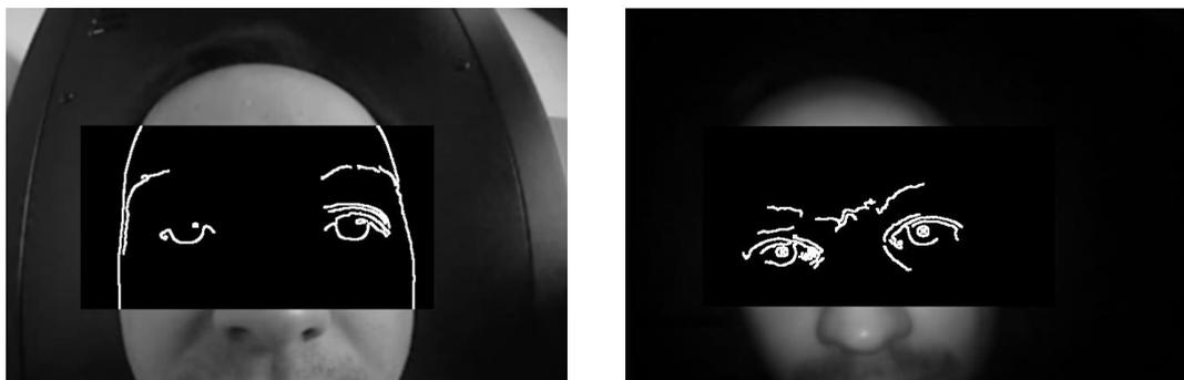
Figura 1 – Região de interesse (ROI) no vídeo colorido (esquerda) e no vídeo com iluminação infravermelha (direita), em ambas as regiões de interesse mostram o resultado da detecção de borda pelo método Canny.
