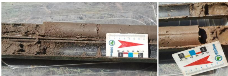
FIGURA 2 – Testemunhos sedimentares com contatos abruptos entre as camadas silto-argilosas e arenosas na Lagoa II.
