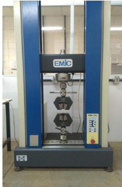
Figura 1: Equipamento utilizado no ensaio de tração dos corpos de prova de aço. Fonte: Autor
