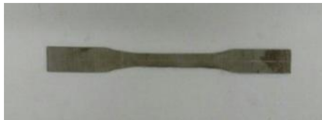
Figura 2: Corpo de prova antes do ensaio. Fonte: autor.
