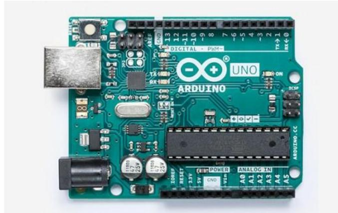
**Figura 1:** Placa de desenvolvimento Arduino UNO. Fonte: (ARDUINO, 2018).
