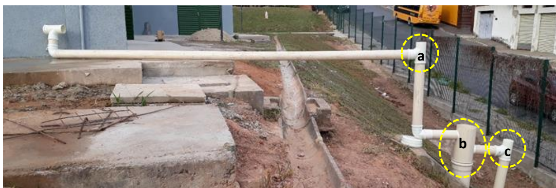
Figura 1 – Santa Luzia – Sistema experimental montado (a) Dosagem de sedimento; (b) RSPA; (c) ponto de amostragem.
