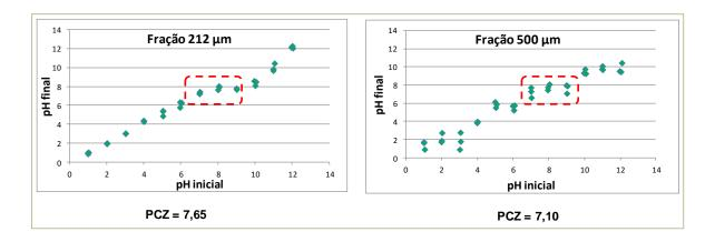
Figura 3. Estudo do pH do ponto de carga zero (PCZ) para o joá previamente tratado com HCl 0,1 M.
