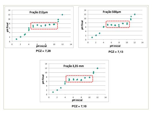
Figura 2. Estudo do pH do ponto de carga zero (PCZ) para o joá sem tratamento.
