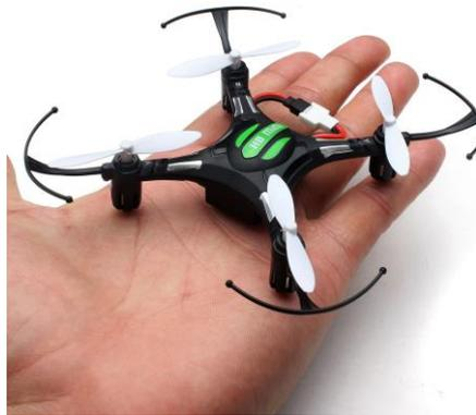
**Figura 2.** Modelo de drone utilizado na planta didática, Eachine H8 Mini, com dimensões aproximadas de 13.5x13.5x2.8 cm. O controle remoto que acompanha o produto não foi utilizado. Fonte: [www.eachine.com](http://www.eachine.com)
