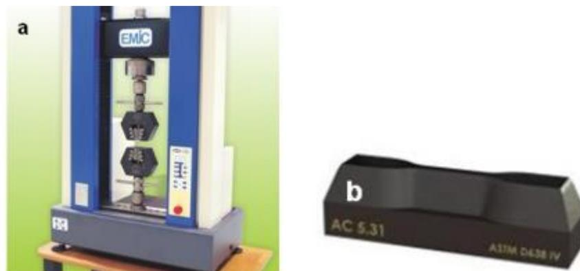
Figura 1: (a) Máquina Universal de Ensaio modelo EMIC DL 20000 (IFMG - Mecânica) e (b) Faca de corte para estampagem de corpos de prova tipo IV segundo a norma ASTM D638.
