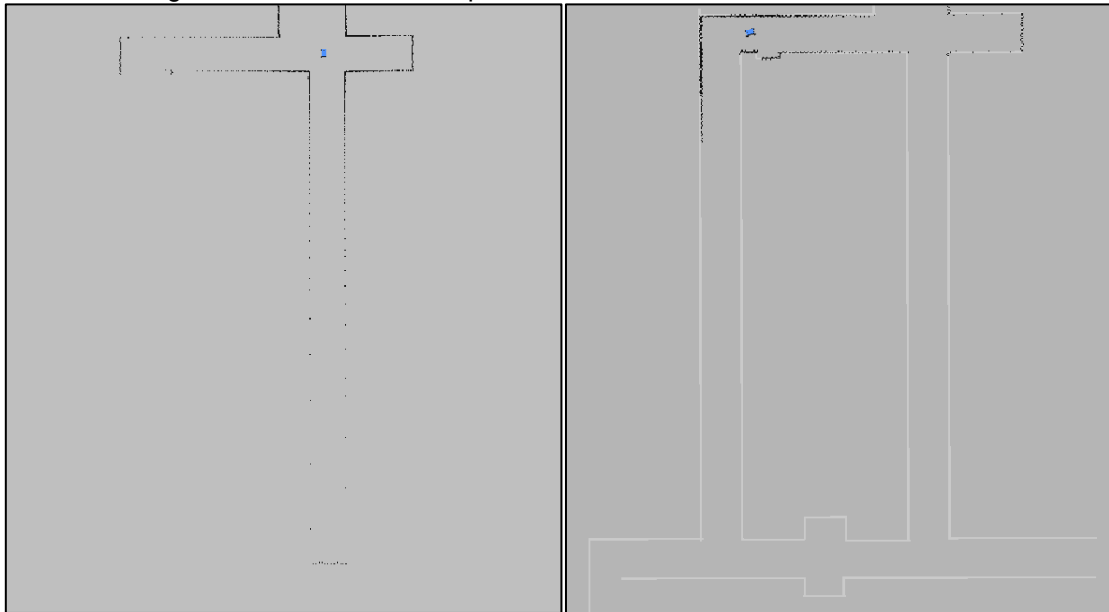
Figura 3 - Resultado do mapeamento local utilizando o sensor LIDAR.
