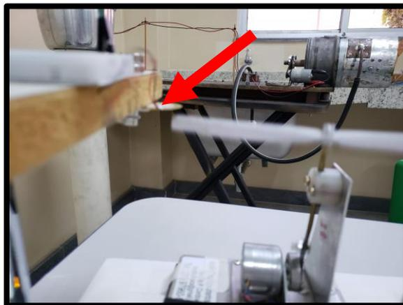
Figura 4 – Protótipo evidenciando a posição da pastilha, fixada por uma extremidade em uma haste, sendo deformada pela movimentação do motor. Fonte: autores (2022).
