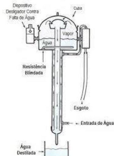
Figura 1: Destilador do tipo Pilsen
