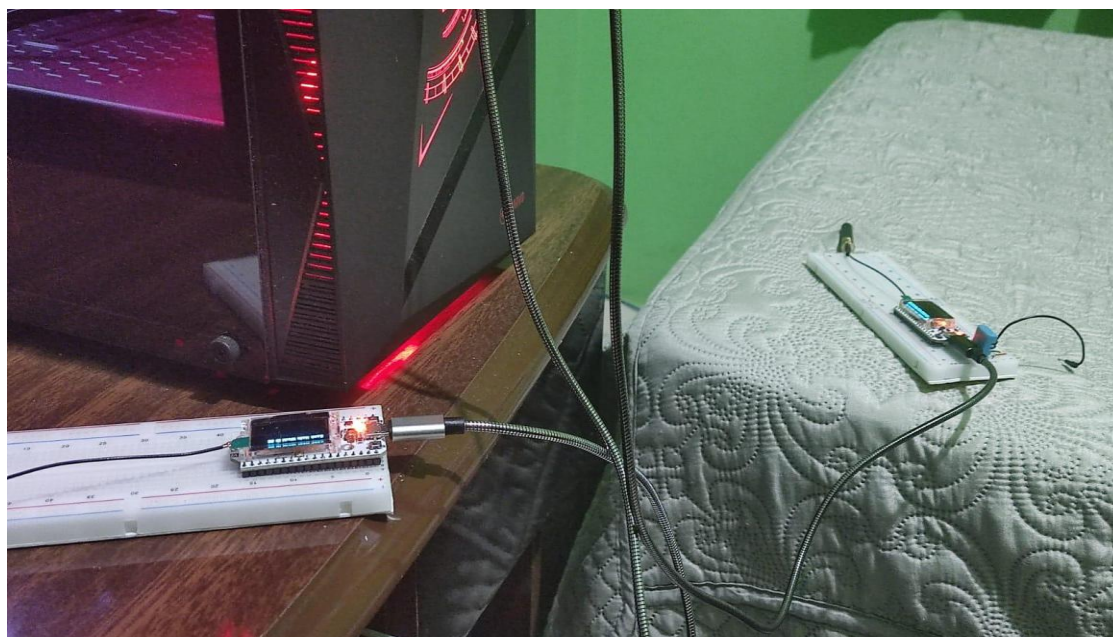
Quadro 1- Heltec ESP32 WIFI LoRa (V2) sx1276 utilizado na configuração de dispositivos iguais. Fonte: Elaborado pelo Autor.
