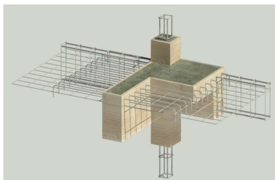
a) Fôrmas planejadas
